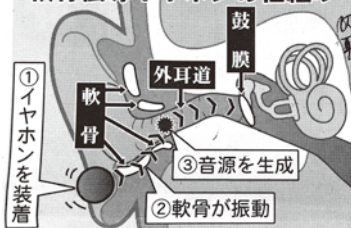
軟骨伝導イヤホンの仕組み
