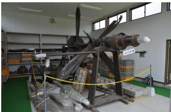
写真 5.2 第八坑扇風機坑口プロペラ
